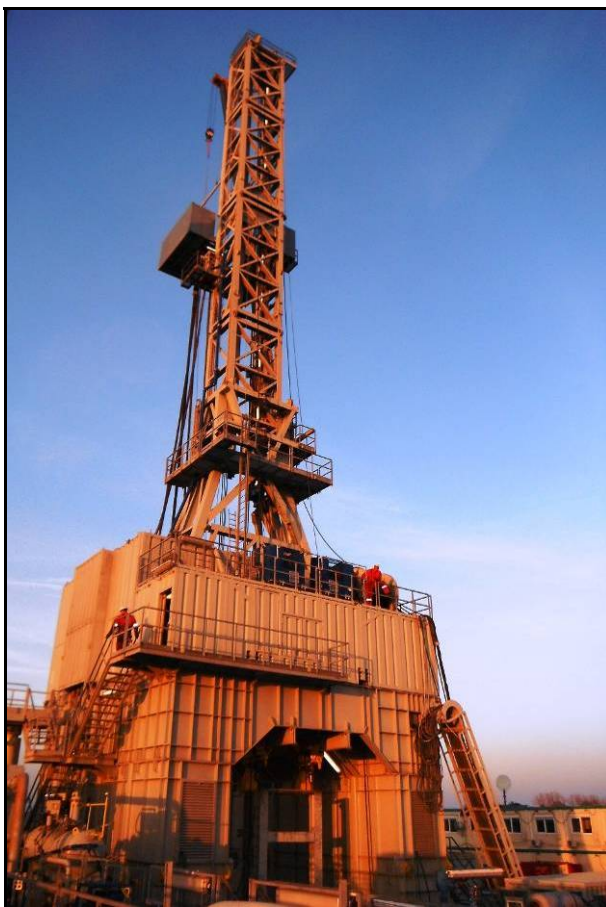
Ryc. 13 Przykładowe urządzenie wiertnicze (urządzenie Bentec 350, odwiert Siciny 2).
