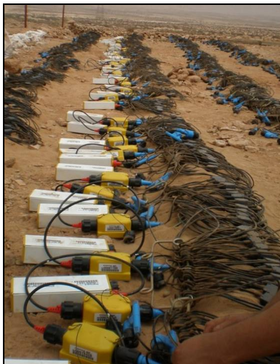
Ryc. 32 Baterie, rejestratory oraz geofony ułożone w wiązki i przygotowane do pracy (źródło: www.novaseis.eu ).
