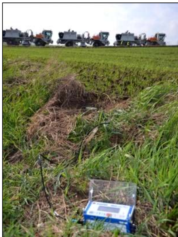
Ryc. 33 Pomiar ruchu cząstek ośrodka gruntowego w czasie pracy wibratorów – tzw. badanie PPV (określanie wpływu wibracji na budynki i inne wrażliwe na wibracje miejsca).
