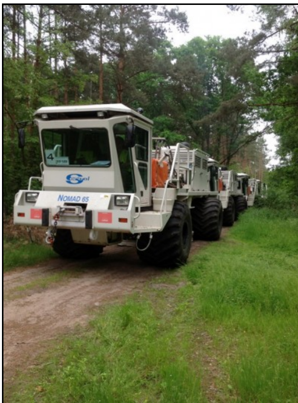
Ryc. 3 Prace sejsmiczne - wibratory pracujące w terenie [źródło: www.novaseis.eu ].
