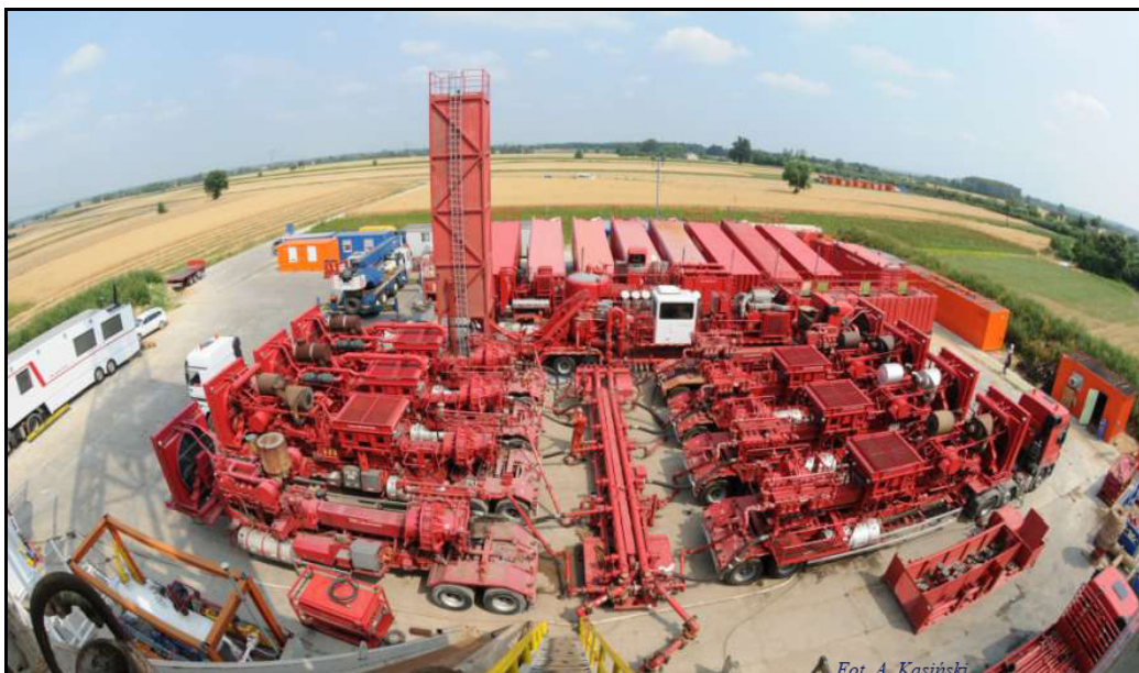
Ryc. 8 Fragment terenu wiertni podczas etapu szczelinowania, widok ze stołu wiertniczego – odwiert Markowola 1 [źródło: Jakiel M., Potera J., 2011].
