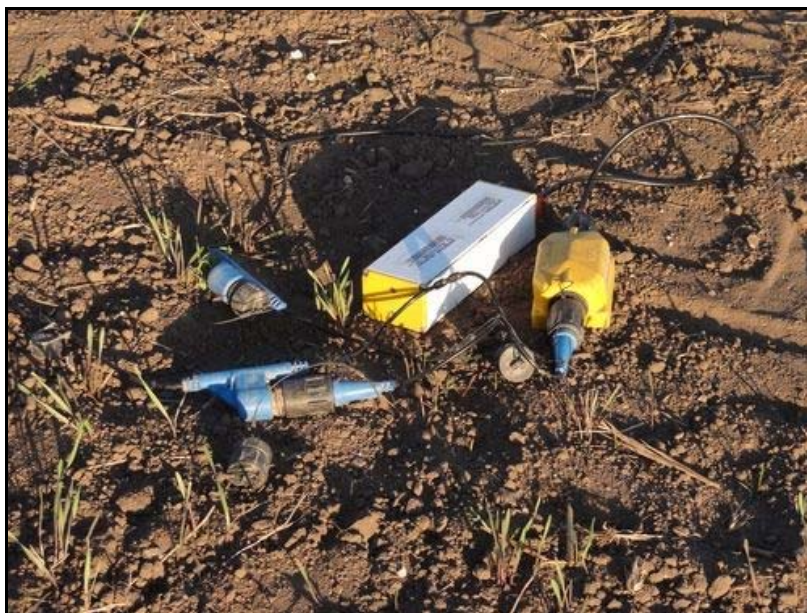
Ryc. 30 Przykładowy sprzęt wykorzystywany podczas prac sejsmicznych - bateria zasilająca oraz rejestrator.
